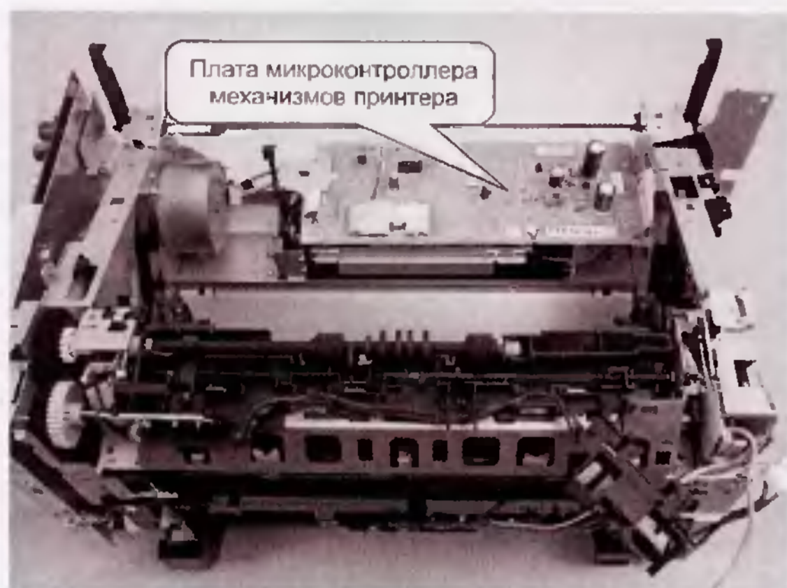
Рис. 12. Расположение платы Engine Controller PCB в МФУ HP LJ 3050
