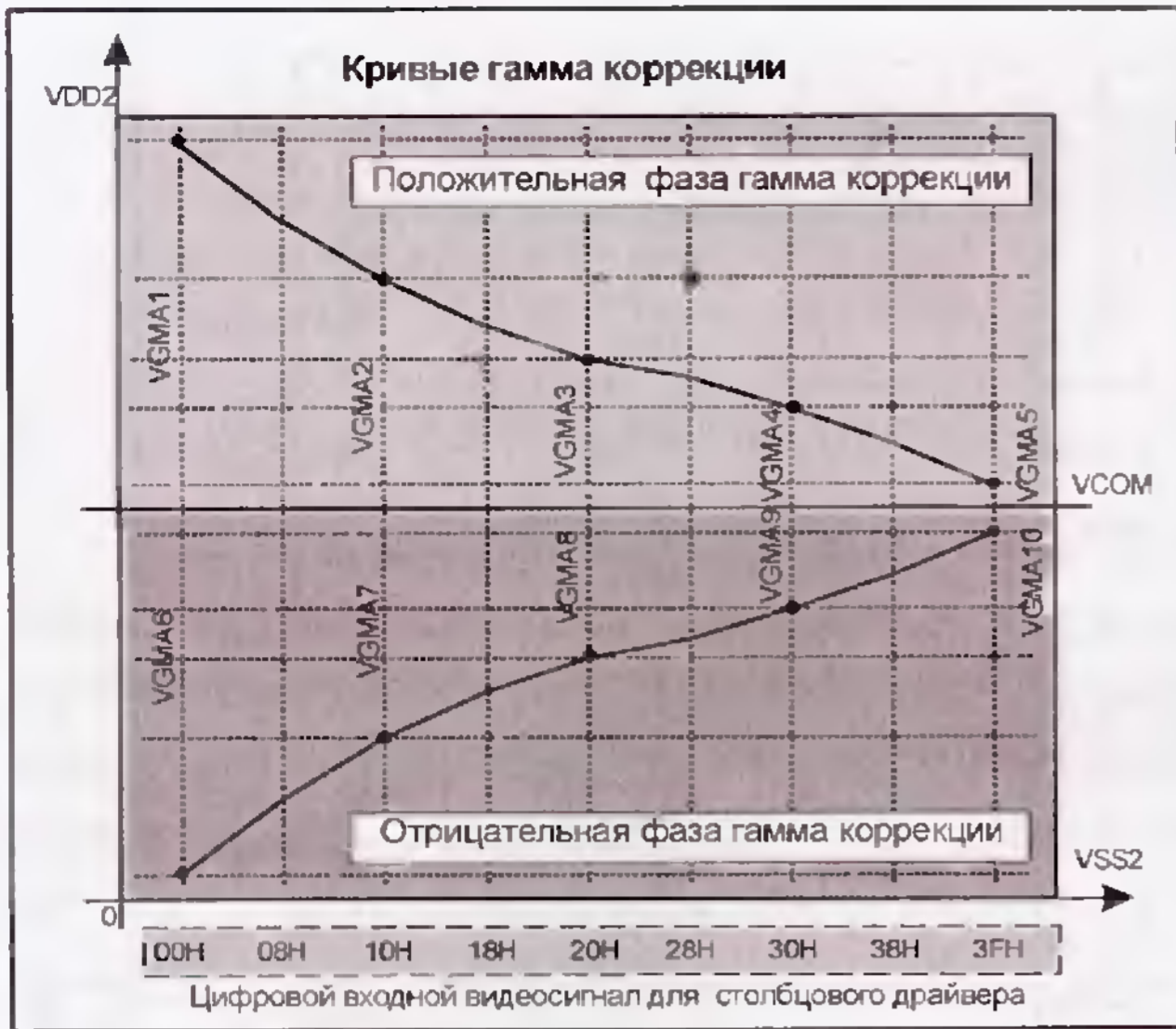
Рис. 7. Зависимость опорных напряжений полутонов и напряжения для общего электрода.
