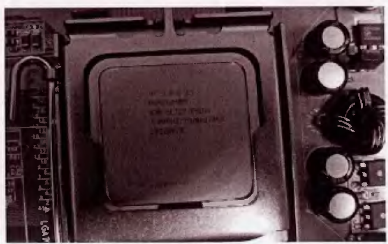
Рис. 7. Осторожно сформировали выводы разъема Socket 775 и установили процессор PENTIUM 4 3.00GHZ/2M/800/04A
